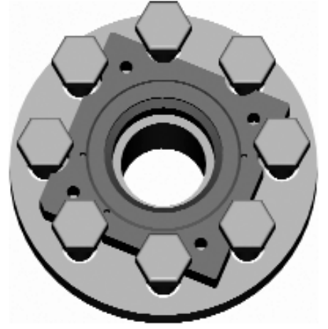
Figura 3 Alojamento modelo SRB-7RS™ posicionado no flange de processo
