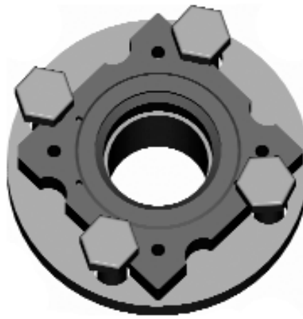
Figura 3 Alojamento modelo SRB-7RS™ posicionado no flange de processo
